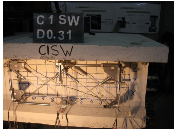
(d) Shear crack pattern before failure
