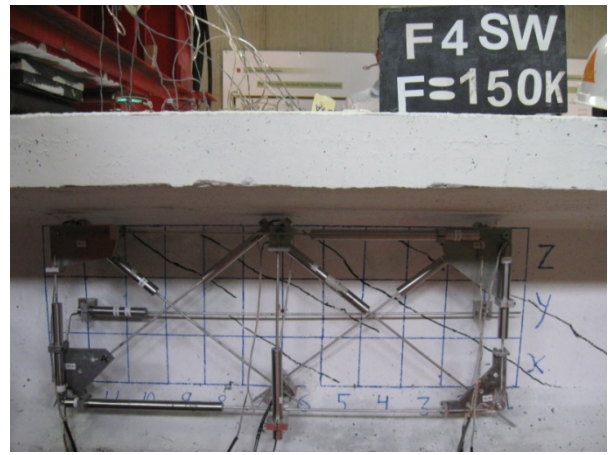
(d) Shear crack pattern before failure
