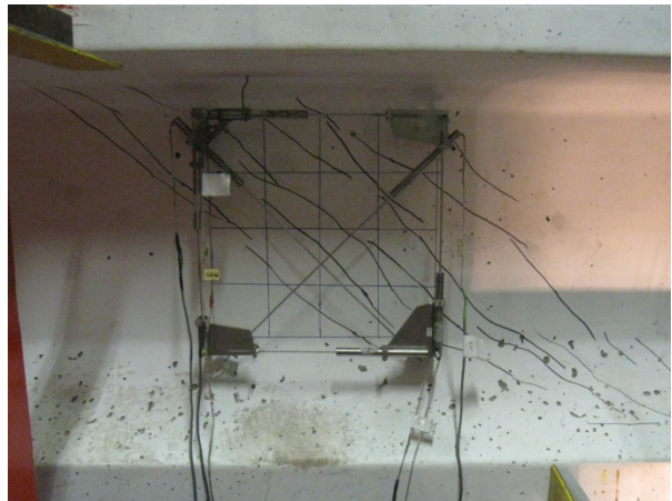
(d) Shear crack pattern before failure
