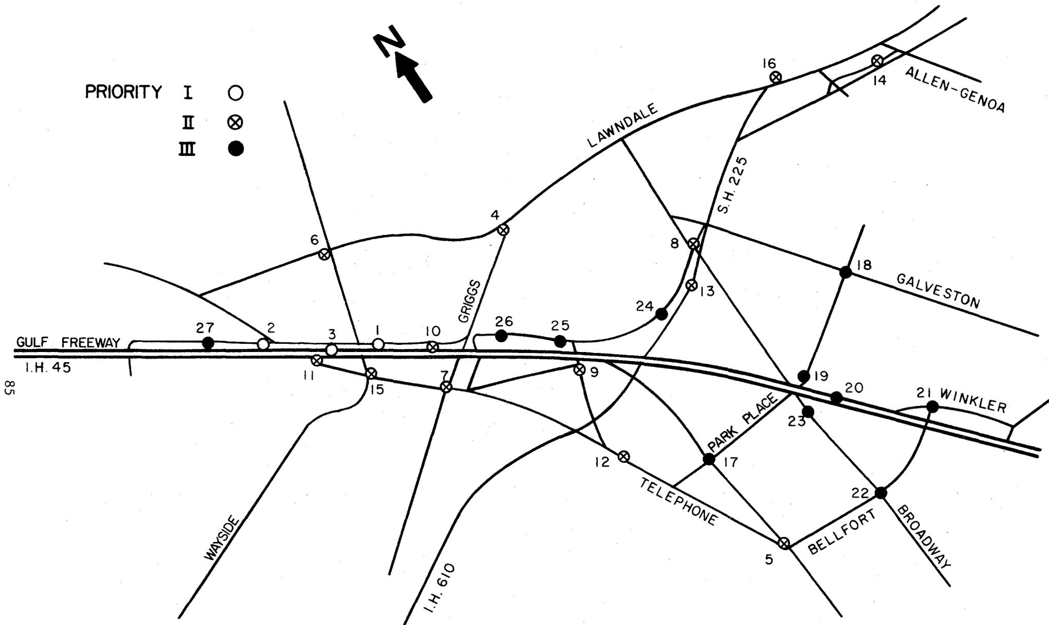
FIGURE 28 - RECOMMENDED LOCATIONS FOR REAL-TIME FREEWAY TRAFFIC INFORMATION DISPLAYS FOR INBOUND GULF FREEWAY CORRIDOR
